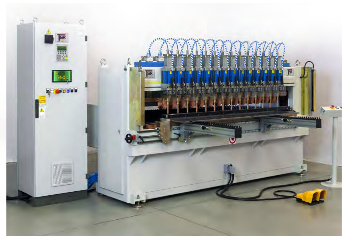
▷ VIELPUNKT SCHWEISSMASCHINE M.F. • SCHWEISSEN IN MITTELFREQUENZTECHNIK • PROGRAMMIERUNGSSCHRITTE MIT AUSWAHL DER EINZELNEN SCHWEISSKÖPFE • RÜCKWÄRTIGER ANSCHLAG ÜBER AUTOMATISCHE, NUMERISCHE KONTROLLE
