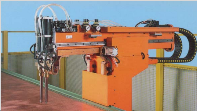
Cart 2 Dreiphasig programmierbare Arbeitsinsel mit 2 Achsen
